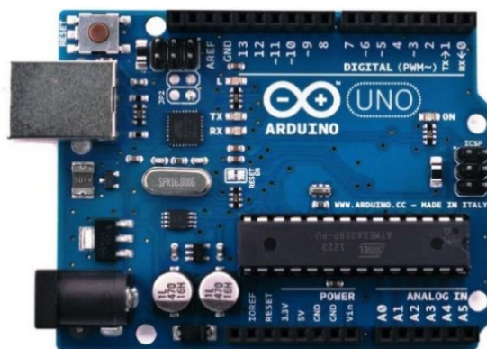
Εικόνα 62: Arduino uno rev.3 πλακέτα ανάπτυξης μικροελεγκτών (microcontroller development board).
