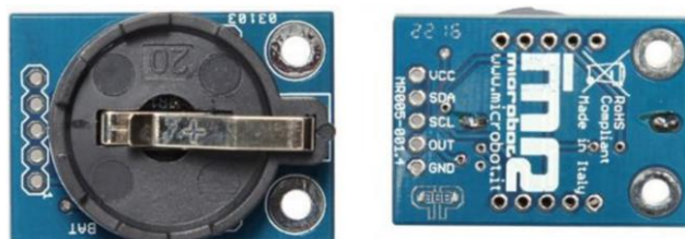
Εικόνα 68: Σειριακό ρολόι πραγματικού χρόνου (Serial Real-Time Clock, RTC) βασισμένο στο clock chip DS1307.
