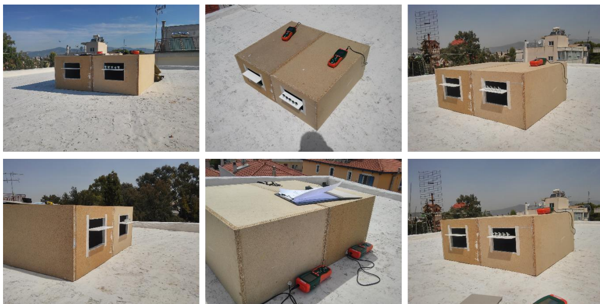
Εικόνα 50: Μοντέλα υπο κλίμακα με το ράφι φωτισμού και το προτεινόμενο ASRS εγκατεστημένα στο δώμα του κτιρίου.
