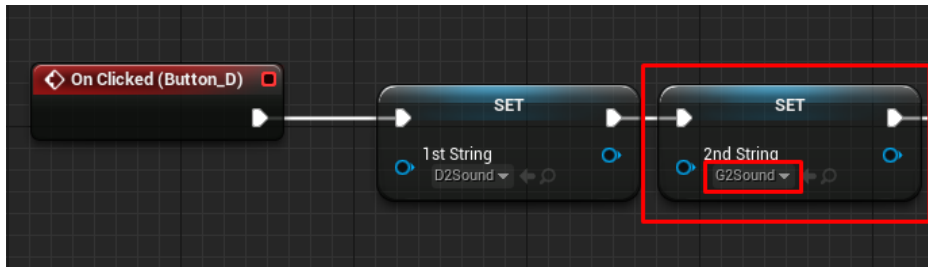
Εικόνα 4.90: Στην μεταβλητή 2nd String εκχωρείται ο ήχος G2Sound
