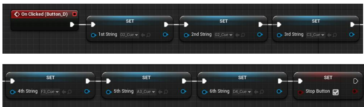
Εικόνα 4.87: Ο κώδικας για το πάτημα του κουμπιού D Tuning
