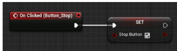
Εικόνα 4.93: Ο κώδικας για το πάτημα του κουμπιού Stop
