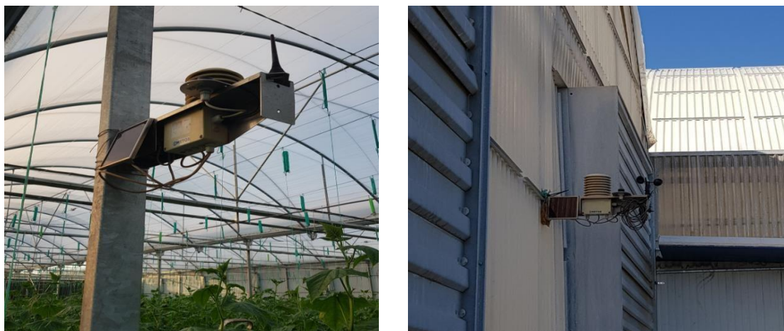
Εικόνα 14. Εσωτερικός μετεωρολογικός σταθμός (αριστερά) και εξωτερικός μετεωρολογικός σταθμός με ανεμόμετρο (δεξιά)
