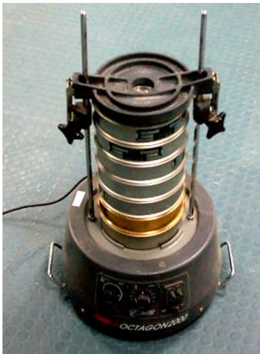
Εικόνα 3.4. Διάταξη συσκευής κοσκνίσματος με έξι κόσκινα διαφορετικών οπών (φωτ. Εργαστήριο Γεωργικής Υδραυλικής, ΠΘ).
