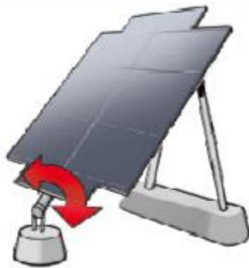
Εικόνα 2.3: Σύστημα «tracker» με παρακολούθηση ηλιακής τροχιάς μονού άξονα (άξονα Y ή άξονα X) [10]
