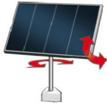
Εικόνα 2.4α: Σύστημα «tracker» με παρακολούθηση ηλιακής τροχιάς διπλού άξονα (X και Y άξονα). [10]
