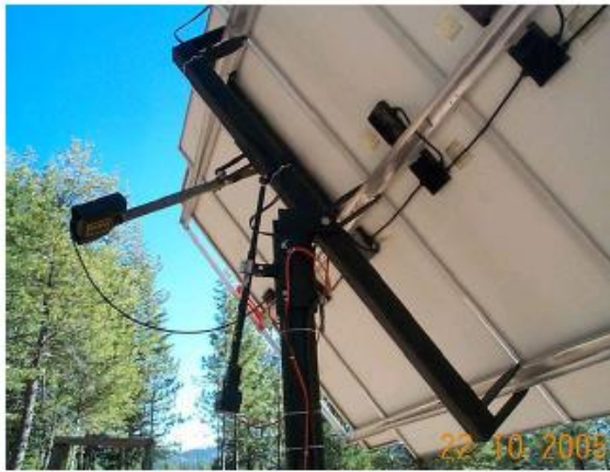
Εικόνα 2.2: Σύστημα «tracker» με παρακολούθηση στον κάθετο άξονα (άξονα X). [2]
