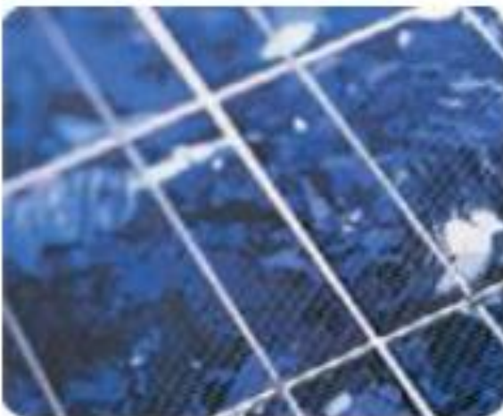
Εικόνα 1.2: Κυψέλη - πολυκρυσταλλικό πυρίτιο [2]
