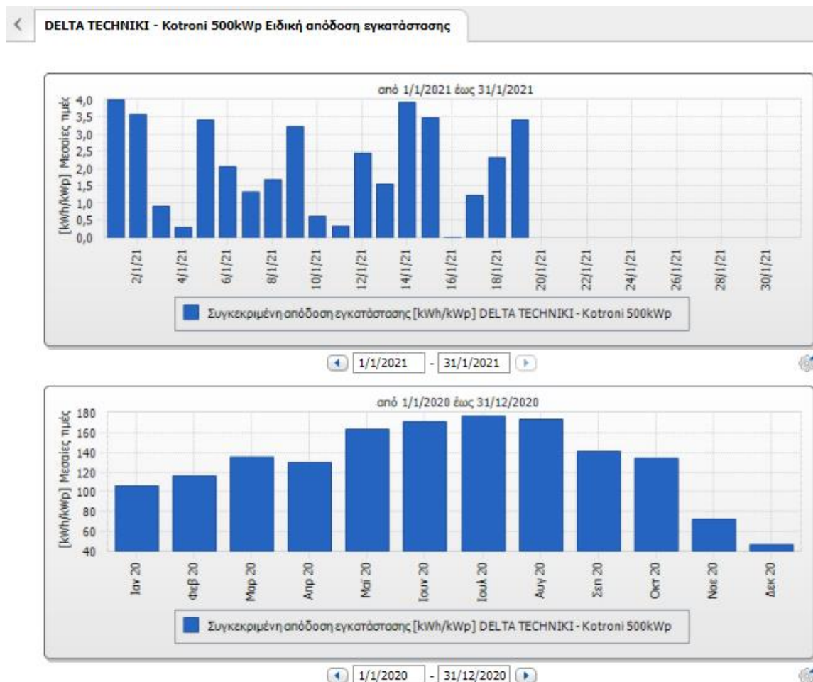
Εικόνα 2.10γ: Δεδομένα για Φωτοβολταϊκό πάρκο 500KWp (ειδική απόδοση εγκατάστασης) [18]
