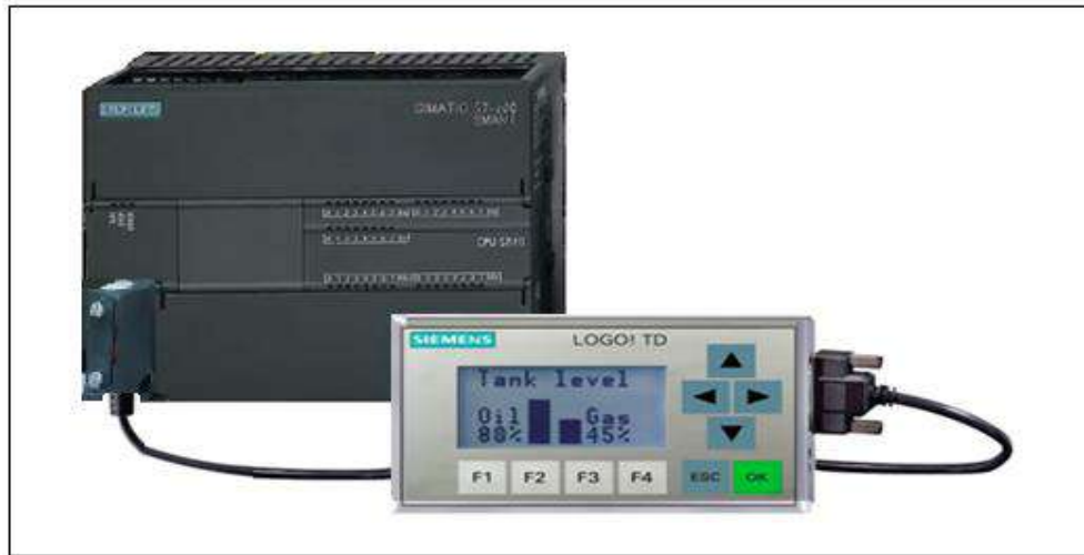
Σχήμα 3.3 Σύνδεση του προγραμματιστή χειρός με το PLC
