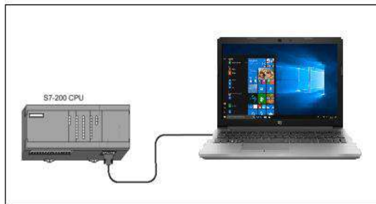
Σχήμα 3.4 Σύνδεση του PLC με προσωπικό υπολογιστή
