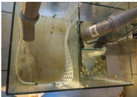
Εικόνα 7. Φίλτρο τύπου sump που χρησιμοποιήθηκε στο σύστημα ενυδρείοπονίας. (Πηγή: Προσωπικό αρχείο)
