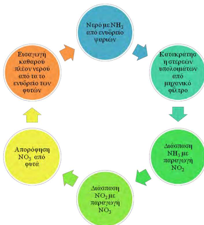
Εικόνα 1. Διαδικασία νιτροποίησης και διάγραμμα ροής νερού σε ένα σύστημα ενυδρειοπονίας και οι αλλαγές που υφίσταται. (Πηγή: Προσωπικό αρχείο)
