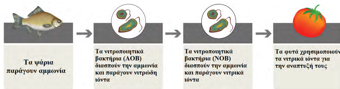
Εικόνα 2. Η νιτροποιητική διαδικασία σε ένα σύστημα ενυδρείοπονίας. (Πηγή: Sommerville et al. 2014)
