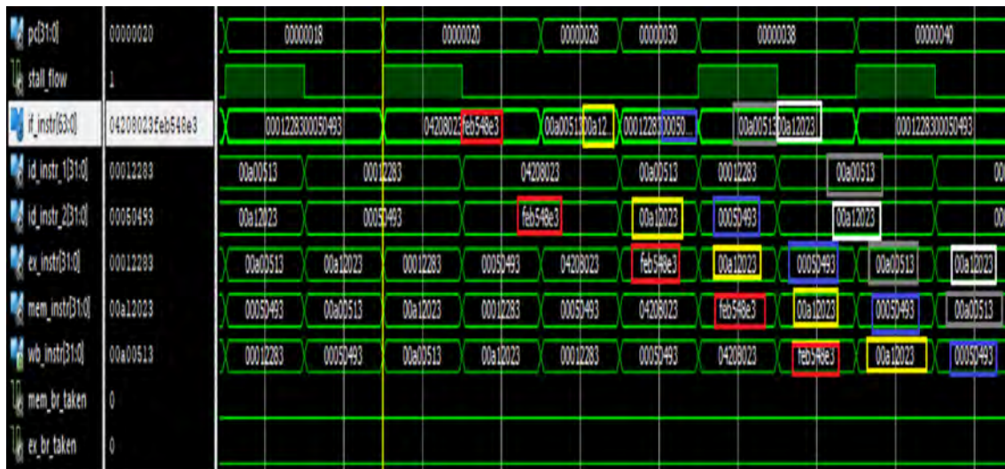
Σχήμα 6.2: Έκδοση και εκτέλεση εντολών μετά απο εντολή διακλάδωσης με ψευδή αποτίμηση
