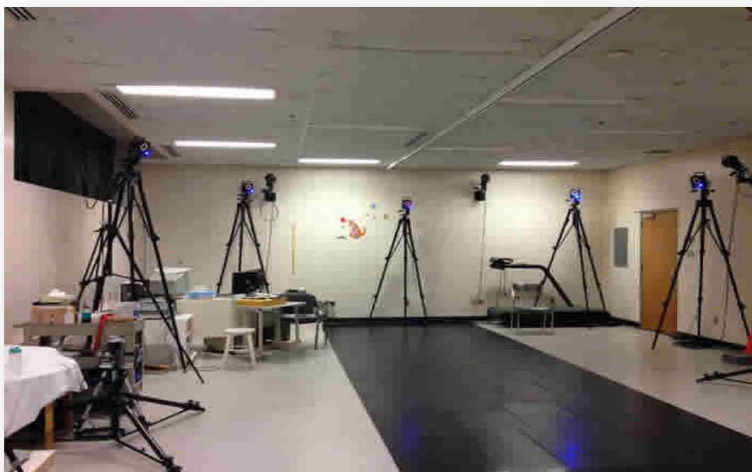
Εικόνα 2.16. Εργαστήριο με οπτοηλεκτρονικό σύστημα καταγραφής της κίνησης. (πηγή: http://www.polymtl.ca )
