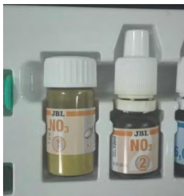
Εικόνα 11. Μέθοδος μέτρησης των νιτρικών ιόντων (Πηγή: προσωπικό αρχείο)
