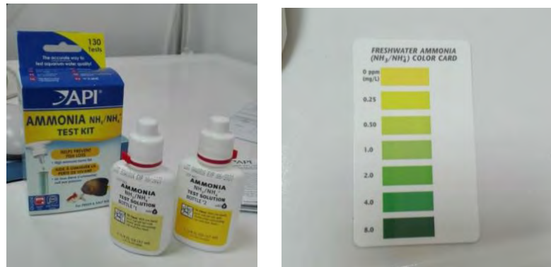
Εικόνα 9. Μέθοδος μέτρησης αμμωνίας (πηγή προσωπικό αρχείο)
