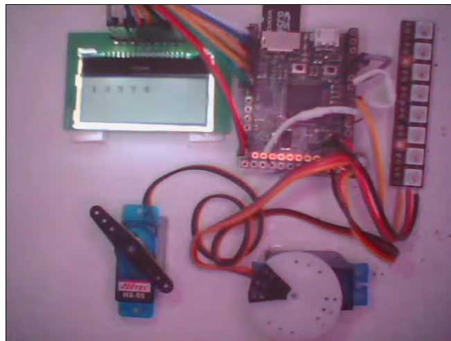
Εικόνα 29: Εμφάνιση των θετικών μονοψήφιων περιττών αριθμών στην LCD οθόνη 41
