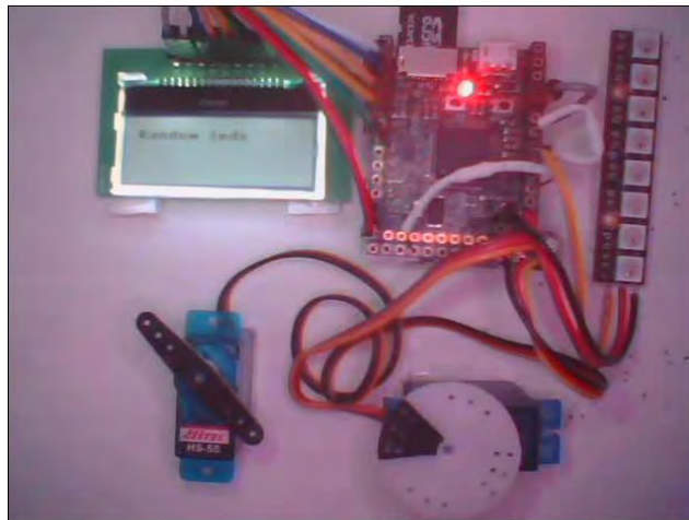
Εικόνα 31: Εμφάνιση του μηνύματος «Random leds» στην LCD οθόνη, άναμμα του κόκκινου led (τυχαίο) και τερματισμός της επανάληψης 43
