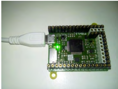
Εικόνα 28: Ένα αναμμένο led (πράσινο) που σημαίνει ότι η δεύτερη συνθήκη είναι True.
