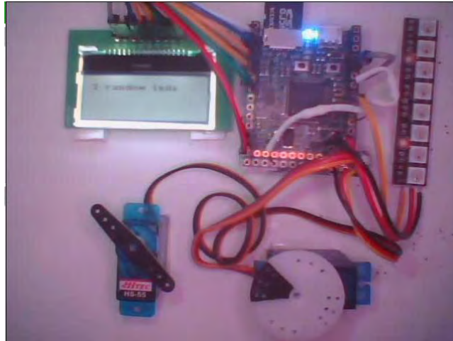
Εικόνα 33: Εμφάνιση του μηνύματος «3 Random leds» στην LCD οθόνη και άναμμα του μπλε led (τυχαίο) 45
