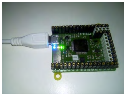
Εικόνα 26: Τρία αναμμένα led (μαζί με το πράσινο) που σημαίνει ότι η συνθήκη είναι False.
