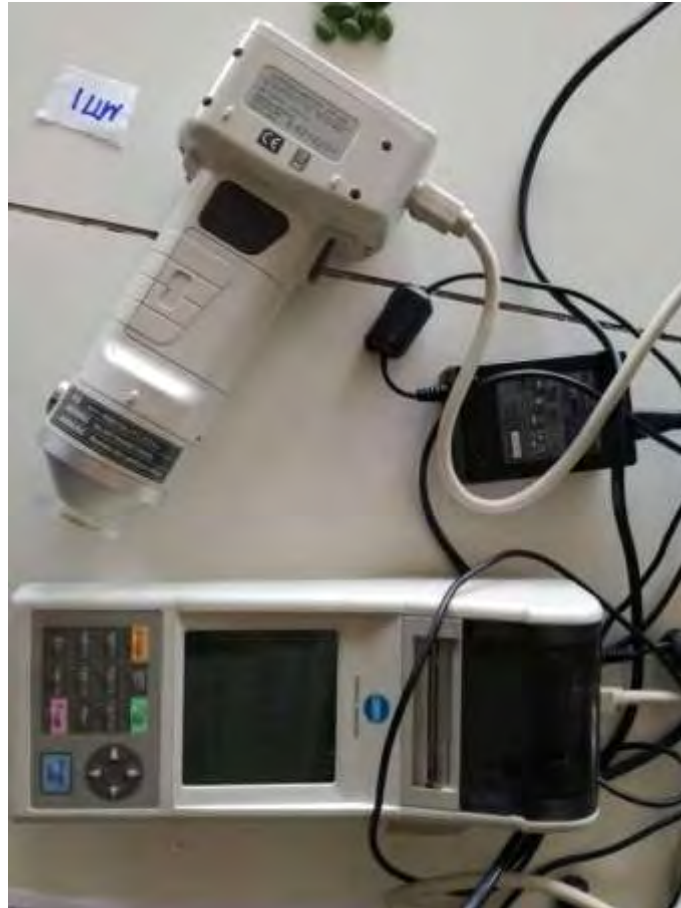
Εικόνα 2.4 Χρωματόμετρο Minolta που χρησιμοποιήθηκε στις μετρήσεις της φωτεινότητας και του χρώματος των καρπών.
