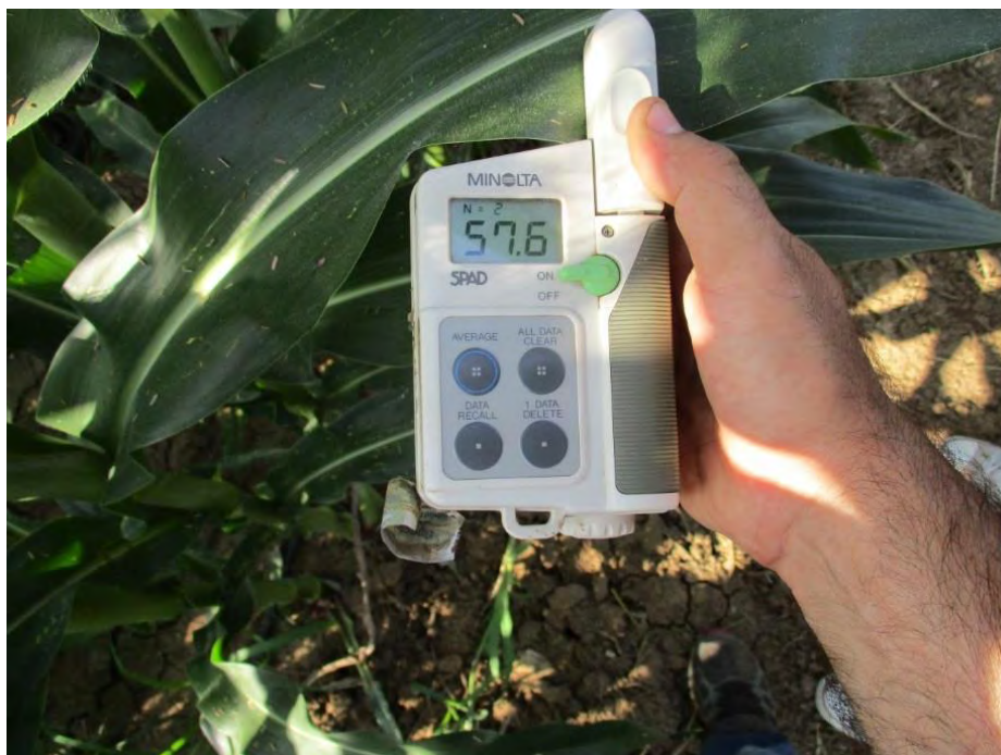
Εικόνα 5. Μέτρηση της συγκέντρωσης χλωροφύλλης με το φορητό όργανο SPAD-502.
