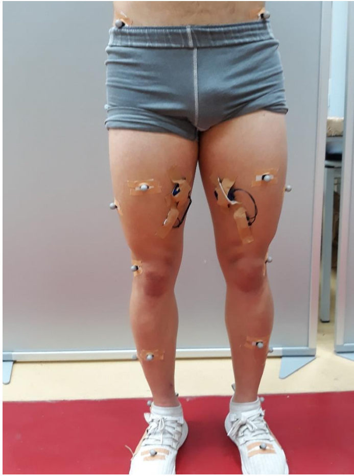
Σχήμα 10. Τοποθέτηση ανακλαστήρων με βάση Schwartz & Rozumalski (2005) από πρόσθια όψη.
