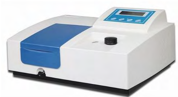
Εικόνα 4 Απεικόνιση φασματοφωτόμετρου που χρησιμοποιήθηκε στο πείραμα.
