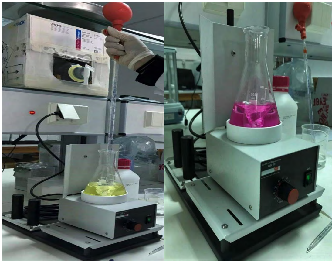
Εικόνα 6 Τιτλοδότηση με υδροχλωρικό οξύ χρησιμοποιώντας δείκτη πριν την αλλαγή χρώματος (αριστερά) και μετά την αλλαγή χρώματος (δεξιά) (Πηγή: Προσωπικό αρχείο)
