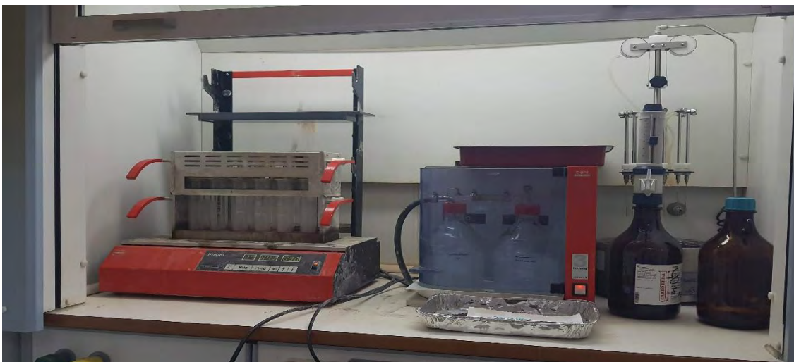
Εικόνα 5 Τοποθέτηση των φιαλών βρασμού σε ειδική συσκευή πέψης που ήταν τοποθετημένη σε επαγωγό (Πηγή: Προσωπικό αρχείο)
