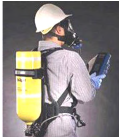
Εικόνα 10: Μάσκα και ειδικό φίλτρο (αριστερά) και αυτόνομη αναπνευστική συσκευή (δεξιά).
