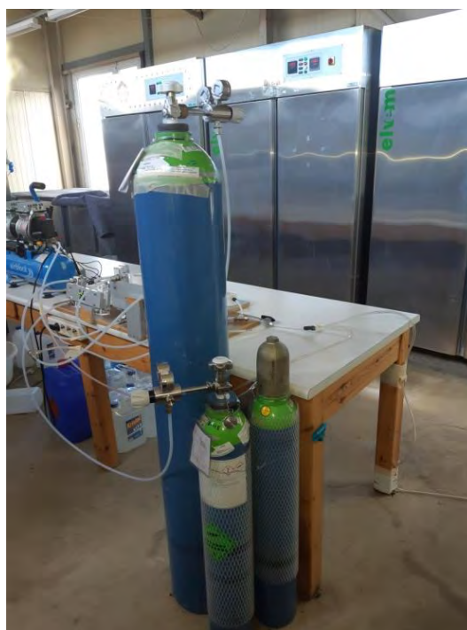
Εικόνα 6: Μίγμα φωσφίνης με διοξείδιο του άνθρακα ή άζωτο υπό πίεση σε κύλινδρο.
