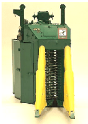
Εικόνα 1.2.1.2: Μηχανισμός συγκομιδής βαμβακιού.
