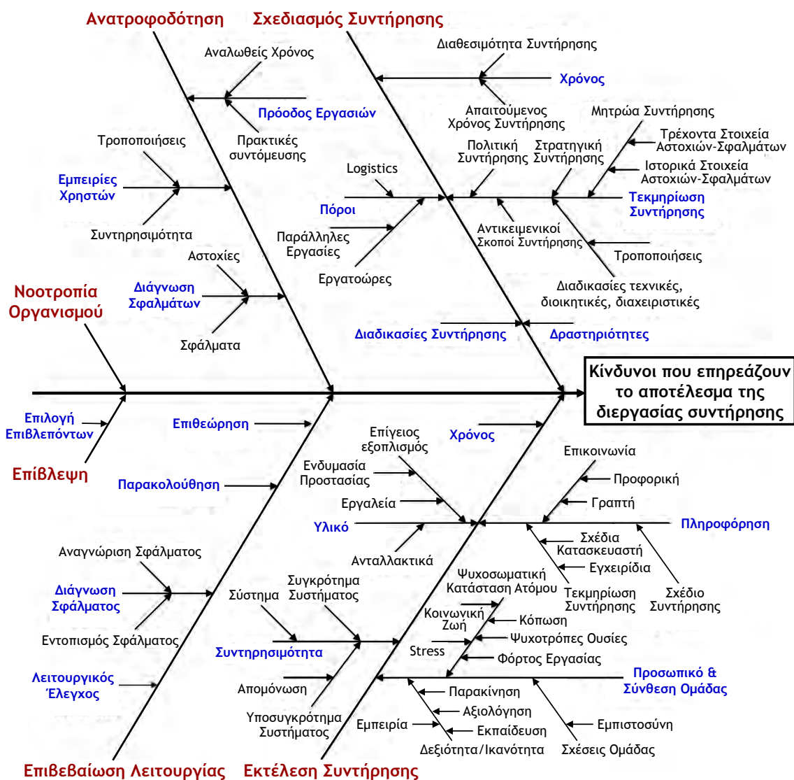
Σχήμα 7.7 Διάγραμμα Ishikawa κινδύνων που δύνανται να επηρεάσουν το έργο και τη διεργασία συντήρησης σε Μοίρα Μαχητικών Αεροσκαφών της ΠΑ.
