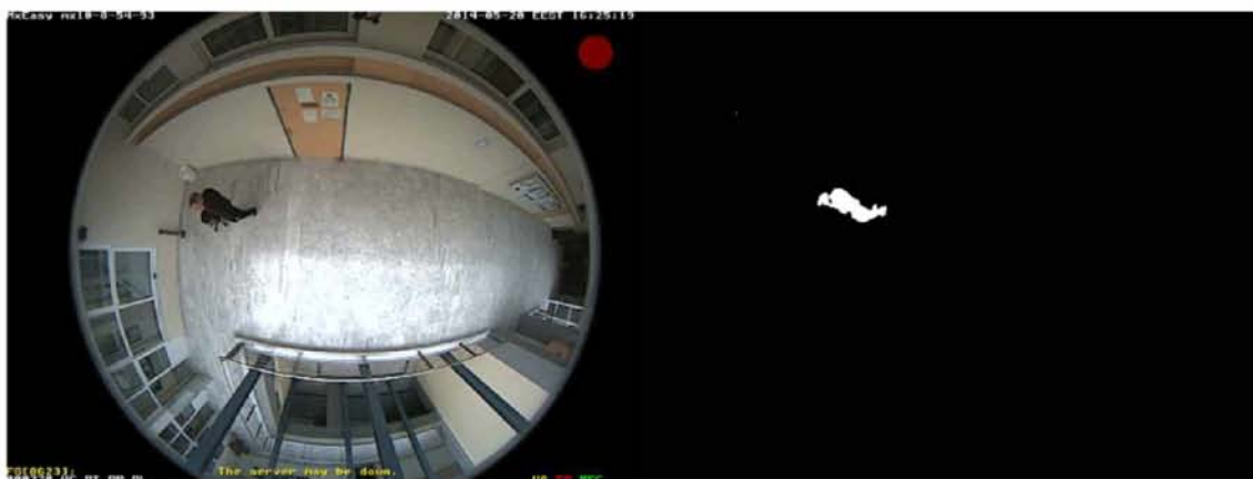
Σχήμα 3.10: Λήψη της στάσης του ανθρώπου μέσω ευρυγώνιας κάμερας, που είναι τοποθετημένη στην οροφή του δωματίου (αριστερά). Τμηματοποίηση της εικόνας και εξαγωγή της ανθρώπινης σιλουέτας (δεξιά).
