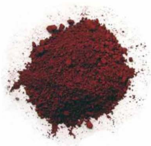
Εικόνα 4.6: Ερυθρά ύλη μετά την απομάκρυνση της υγρασίας
