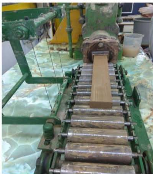
Εικόνα 5.6β: Μορφοποιημένο υλικό κατά την έξοδο
