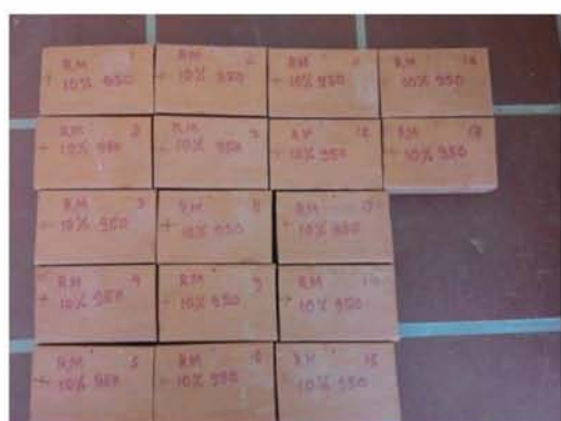
Εικόνα 5.19: 10% Red Mud στους 950°C
