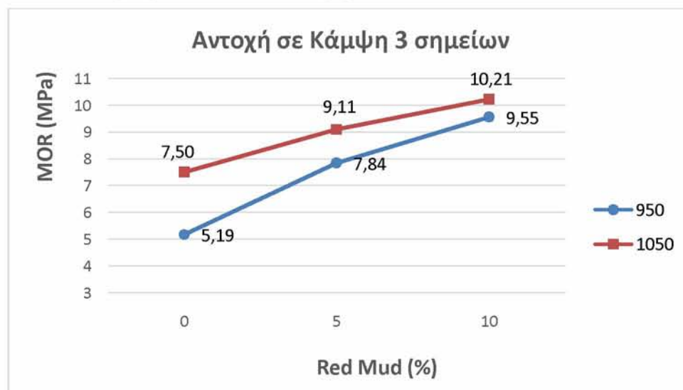
Διάγραμμα 6.5: Επίδραση των αποβλήτων Red Mud στην αντοχή σε κάμψη (MOR) κεραμικών δοκιμίων.
