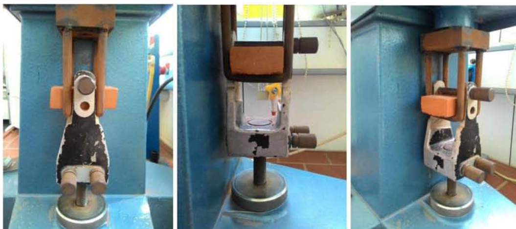
Εικόνα 5.29: Μέρη εμβόλου συσκευής MOR
