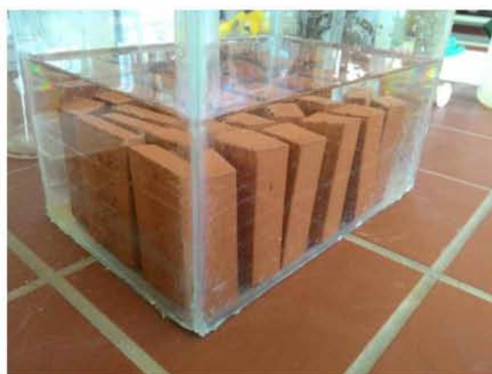
Εικόνα 5.32: Δοκίμια στο νερό για 24ώρες
