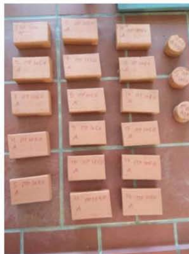
Εικόνα 5.16: Πρότυπα στους 1050°C
