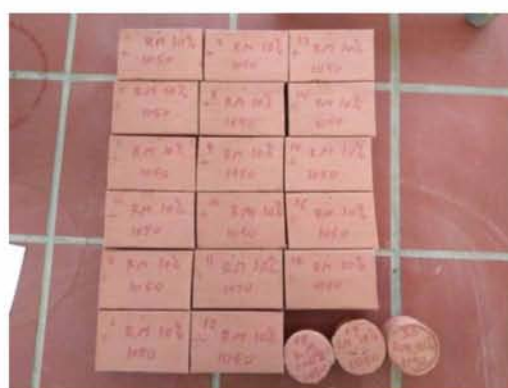
Εικόνα 5.20: 10% Red Mud στους 1050°C
