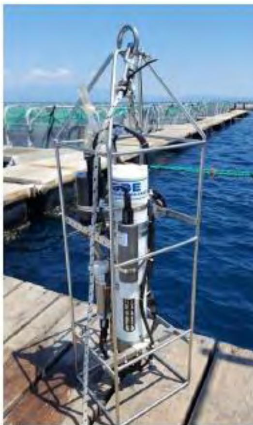
Εικόνα 2.3: Αυτογραφικό όργανο καταγραφής φυσικοχημικών και βιολογικών παραμέτρων του νερού της εταιρείας SeaBirdElectronics.
