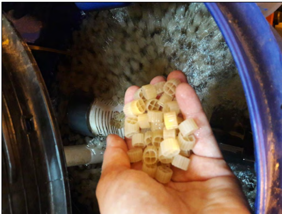
Εικόνα 2.3: Υλικά πλήρωσης K1 στο βιολογικό φίλτρο
