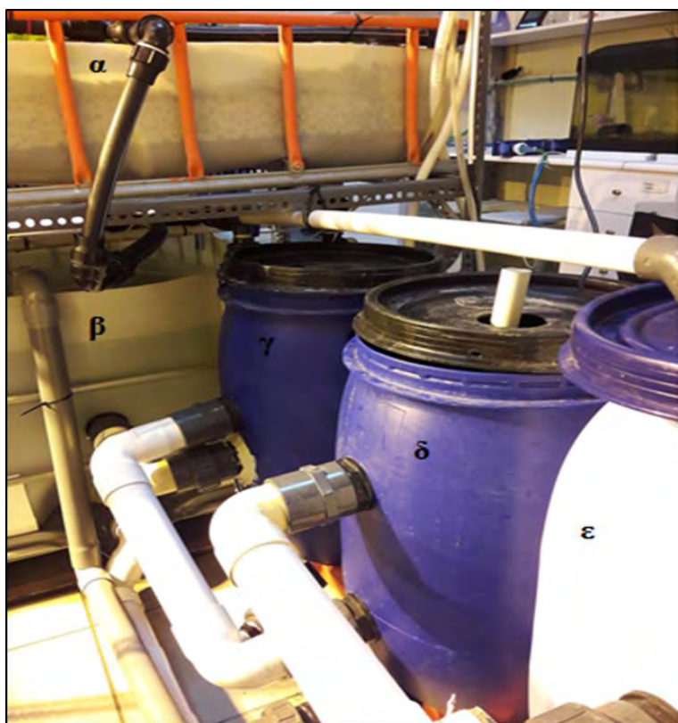
Εικόνα 2.1: α) Δεξαμενή φυτών β) Δεξαμενή ψαριών γ) Μηχανικό φίλτρο δ) Βιολογικό φίλτρο ε) Αντλία νερού
