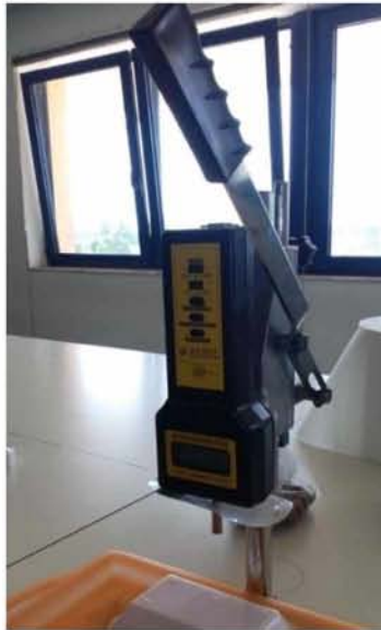
Εικόνα 3.3 Πενετρόμετρο που χρησιμοποιήθηκε για τον προσδιορισμό της συνεκτικότητας της σάρκας καρπών τομάτας.
