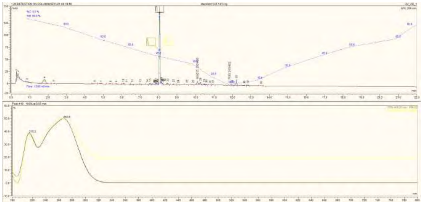
Εικόνα 4.12:Καθορισμός χρόνου έκλουσης της βιταμίνης από την αναλυτική στήλη. Η ταυτοποίηση της βιταμίνης πραγματοποιείται μέσω της απορρόφησης της.
