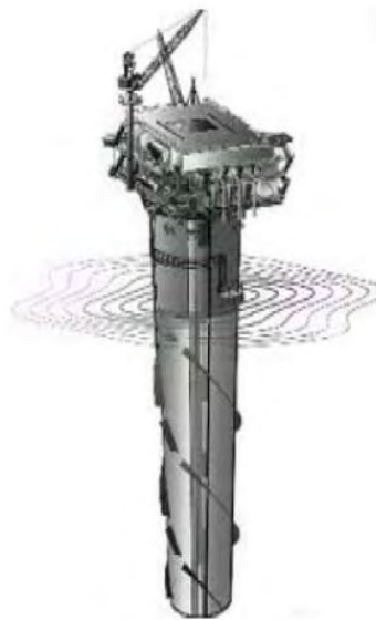
Εικόνα 27: Πλατφόρμα δοκού (spar platform). (Πηγή: Kurian et al., 2013)
