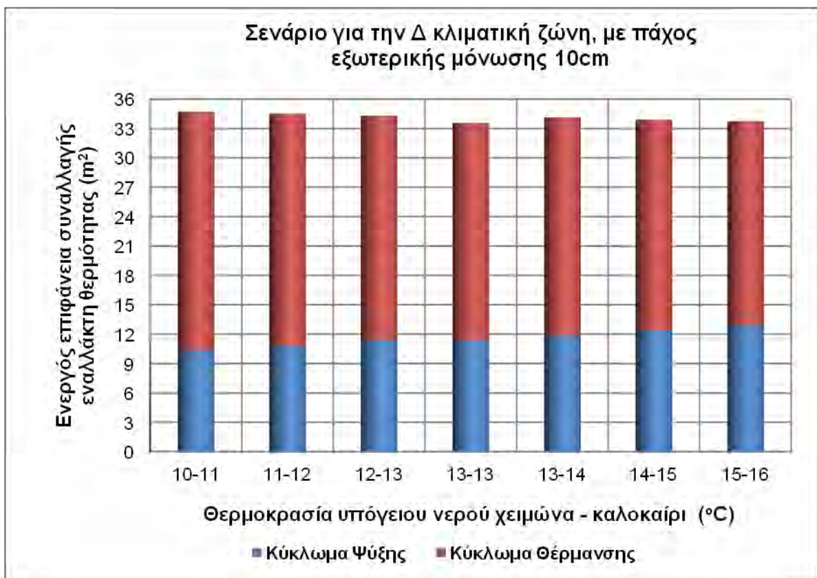
Σχ.6.13. Μεταβολή της ενεργού επιφάνειας συναλλαγής του εναλλάκτη θερμότητας σε σχέση με τη θερμοκρασία του υπόγειου νερού το χειμώνα και το καλοκαίρι για το Σενάριο 4.
