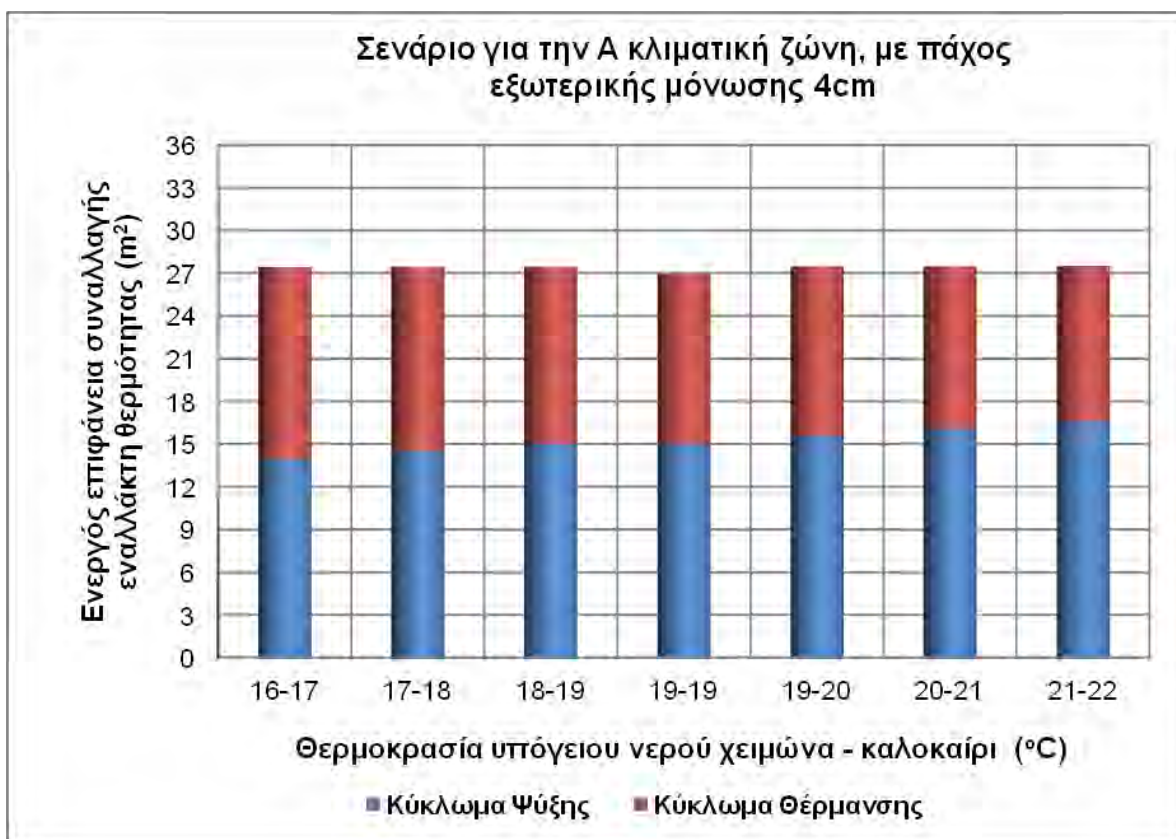
Σχ.6.4. Μεταβολή της ενεργού επιφάνειας συναλλαγής του εναλλάκτη θερμότητας σε σχέση με τη θερμοκρασία του υπόγειου νερού το χειμώνα και το καλοκαίρι για το Σενάριο 1.
