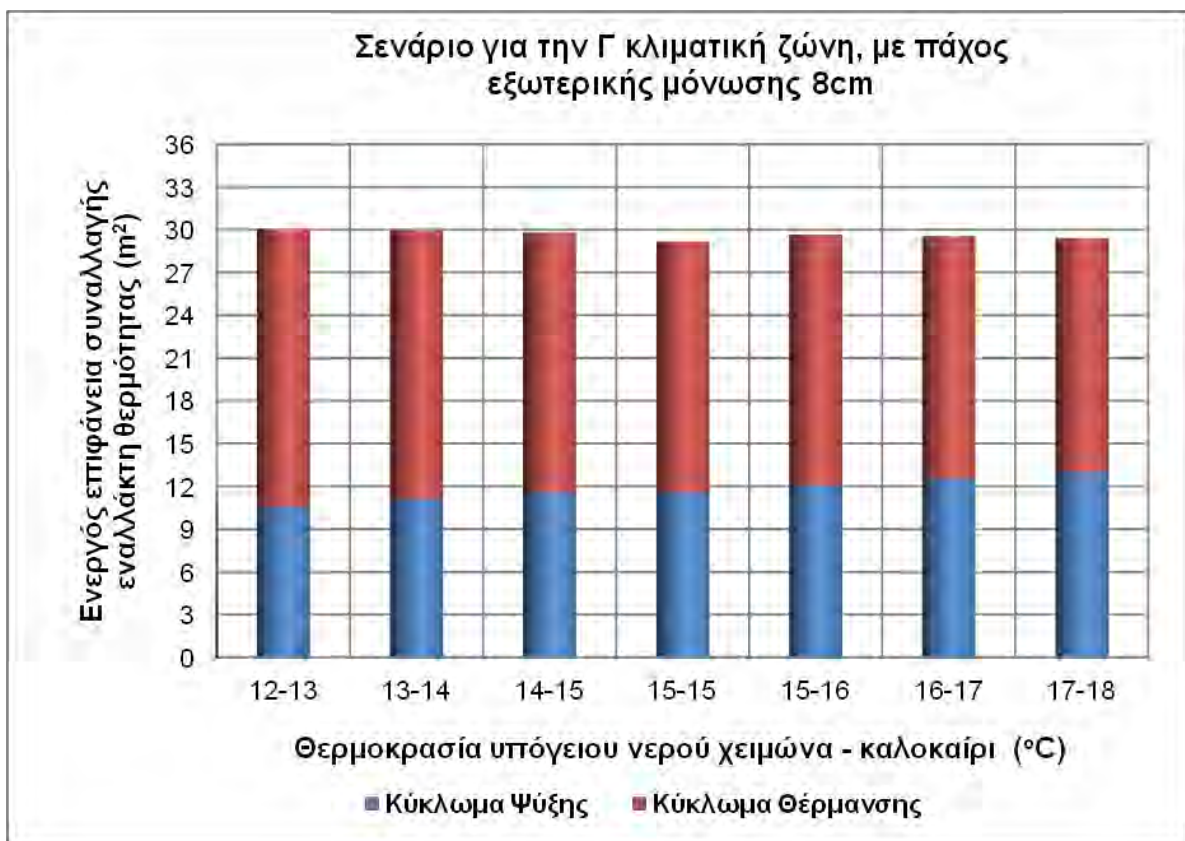
Σχ.6.10. Μεταβολή της ενεργού επιφάνειας συναλλαγής του εναλλάκτη θερμότητας σε σχέση με τη θερμοκρασία του υπόγειου νερού το χειμώνα και το καλοκαίρι για το Σενάριο 3.
