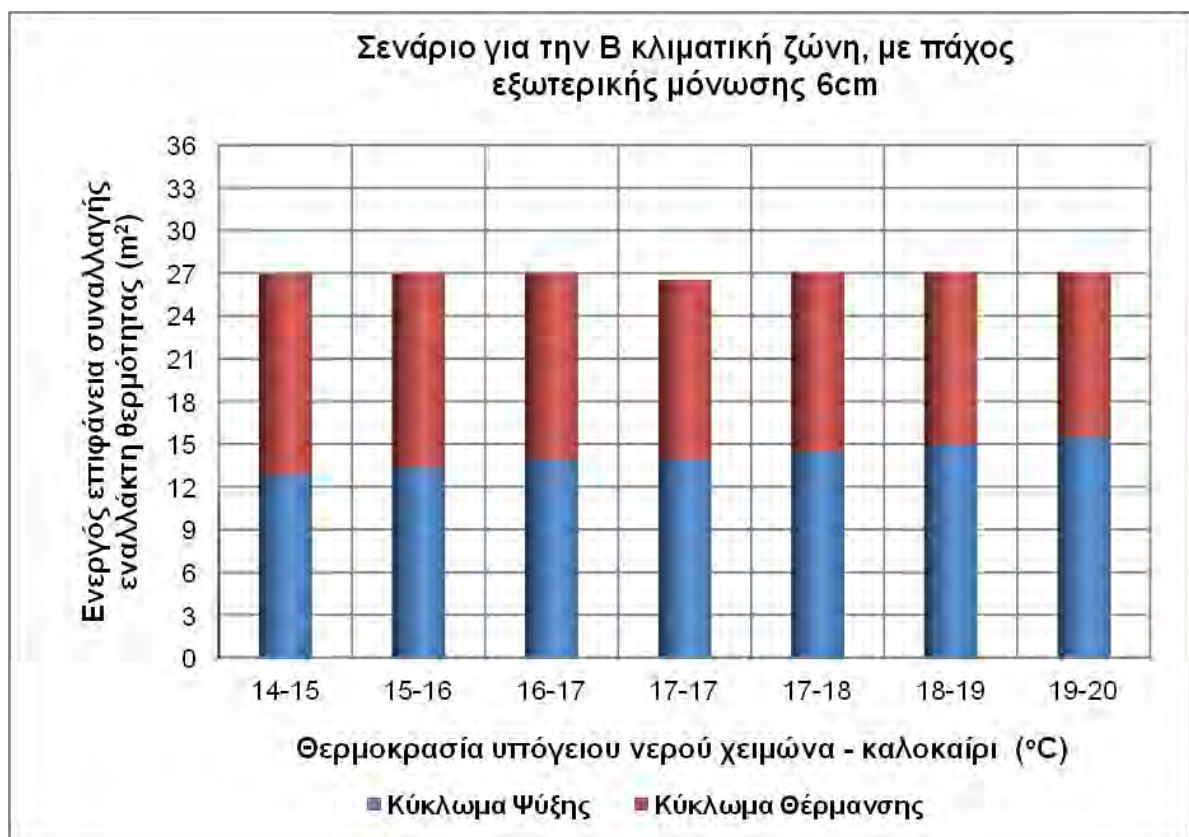
Σχ.6.7. Μεταβολή της ενεργού επιφάνειας συναλλαγής του εναλλάκτη θερμότητας σε σχέση με τη θερμοκρασία του υπόγειου νερού το χειμώνα και το καλοκαίρι για το Σενάριο 2.
