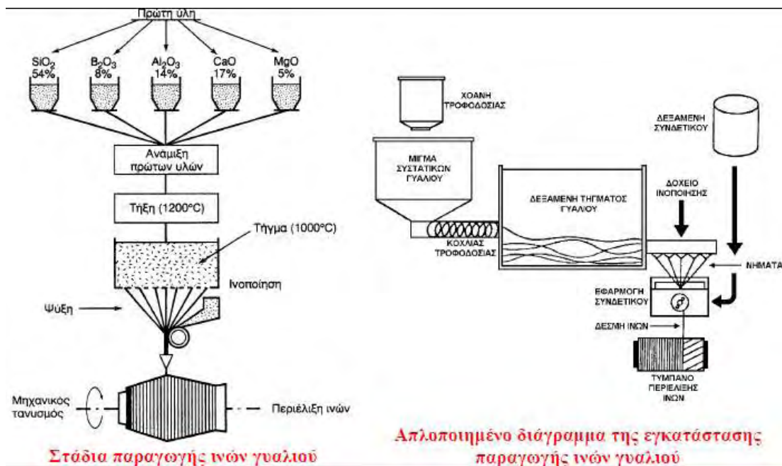
Εικόνα 17 Παραγωγή ενισχυτικών ινών γυαλιού( http://courseware.mech.ntua.gr )
