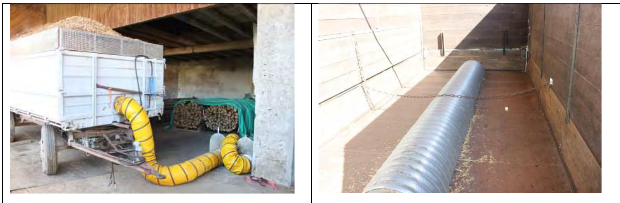
Εικόνα 6.9. Παραδείγματα απλών ξηραντήριων και τεχνική λεπτομέρεια κατασκευής τους ( photo Rutz)
