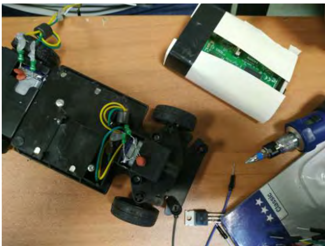
Εικόνα 3. Μόνωση της πλακέτας raspberrypi με χαρτόνι και δημιουργία των κατάλληλων εγκοπών πριν την ενσωμάτωση της στο αυτοκίνητο.
