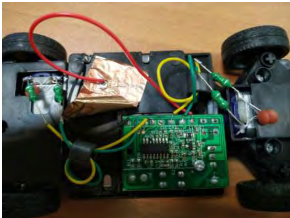
Εικόνα 1. Η αρχική συνδεσμολογία που ήταν ενσωματωμένη στο αυτοκίνητο.
