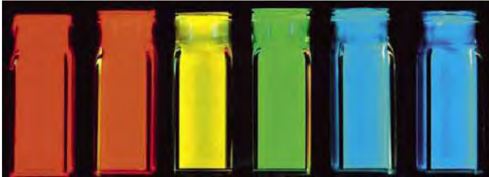
Εικόνα 2.4 Κρύσταλλοι σεληνιακού καδμίου σε διαφορετικό μέγεθος και σχήμα εκθέτονται σε φως διαφορετικών μηκών κύματος. (Schodek, Ferreira, Ashby (2009))
