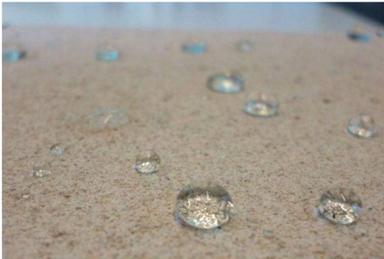
Εικόνα 3.3 Σταγόνες νερού σε ένα τούβλο από σκυρόδεμα με επίστρωση από νάνο-υλικό, που δείχνει πως οι σταγόνες σχηματίζουν σχεδόν σφαιρικό σχήμα (Jones, Gibb, Goodier et al. (2017))
