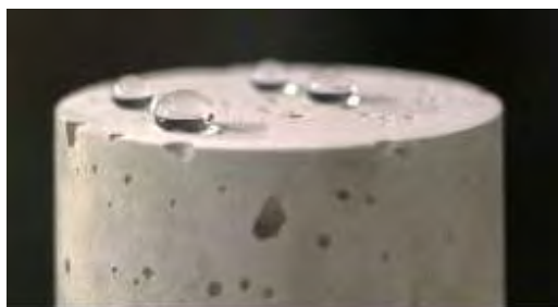
Εικόνα 3.2 Σταγόνες νερού σε υπερευδροφοβική επιφάνεια σκυροδέματος (Arabzadeha, Ceylan, Kimc et al. (2017))
