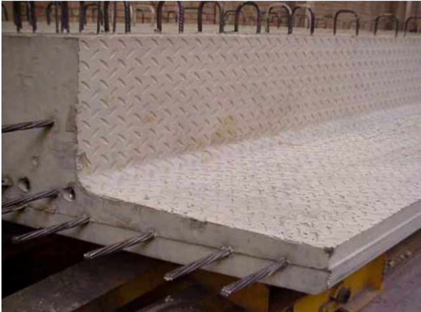
Εικόνα 4.7 Λεπτομέρεια προκατασκευασμένου στοιχείου με αυτοσυμπυκνούμενο σκυρόδεμα. ( https://www.theconcreteinitiative.eu/images/ECP_Documents/EuropeanGuidelinesSelfCompactingConcrete.pdf (2005))
