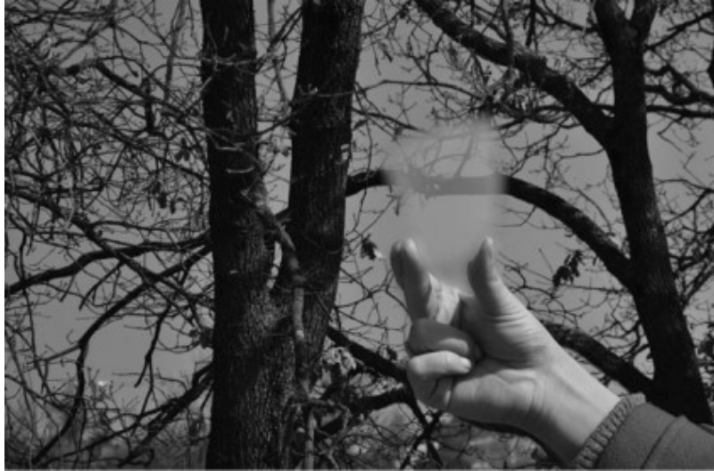
Εικόνα 5.1 Η ορατότητα μέσω ενός δείγματος αεροτζέλ (Pacheco-Torgal, Diamanti, Nazari et al. (2013))
