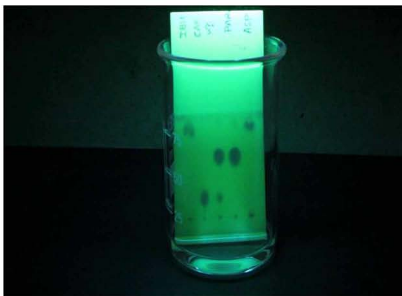
Σχήμα 17: Θάλαμος με το σύστημα διαλυτών
