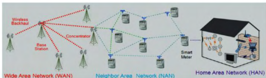
Εικόνα 10: Η αρχιτεκτονική του συστήματος επικοινωνιών [19]
