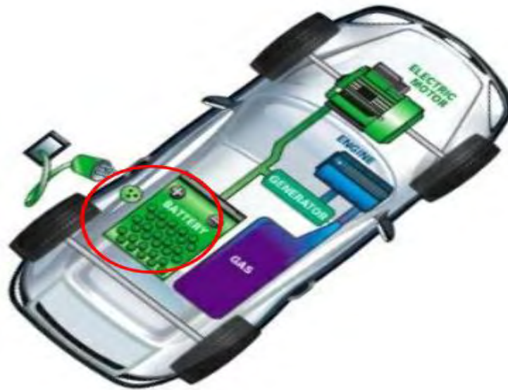
Εικόνα 8: Ηλεκτρικό αυτοκίνητο εκτεταμένης εμβέλειας - Δομή [8]
