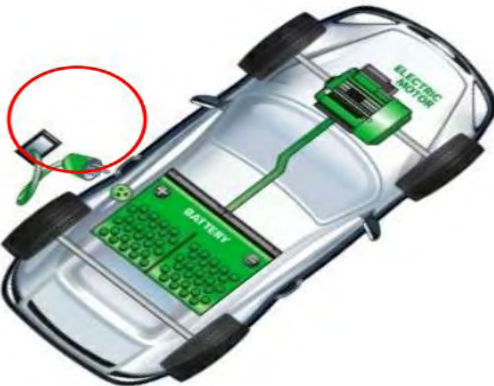
Εικόνα 5: Αμιγώς Ηλεκτρικό Αυτοκίνητο – Δομή [8]
