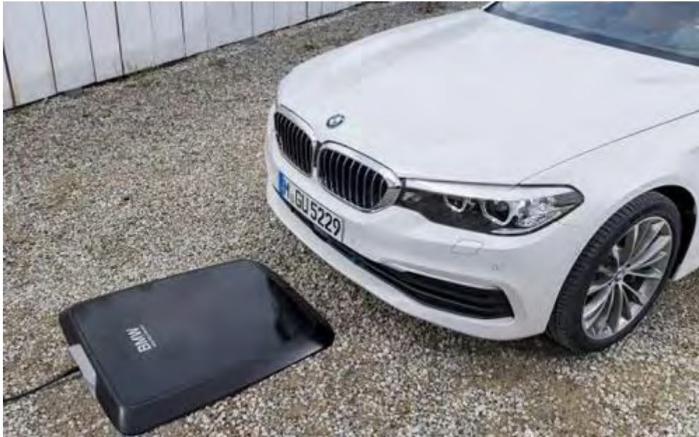
Εικόνα 27: Επαγωγική φόρτιση με Groundpad [21]
