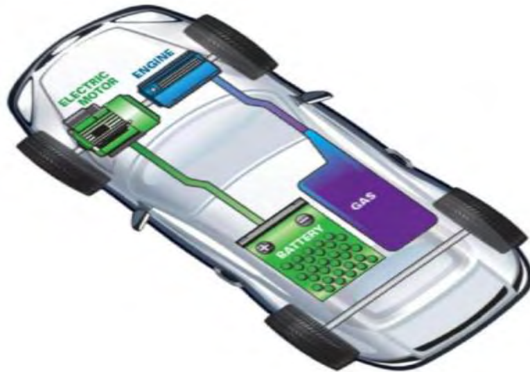
Εικόνα 6: Υβριδικό Αυτοκίνητο – Δομή [8]
