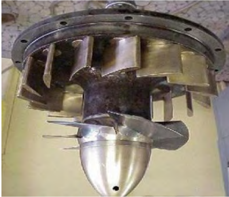
Σχήμα 2.15: Έλικά στροβίλου Kaplan[31]
