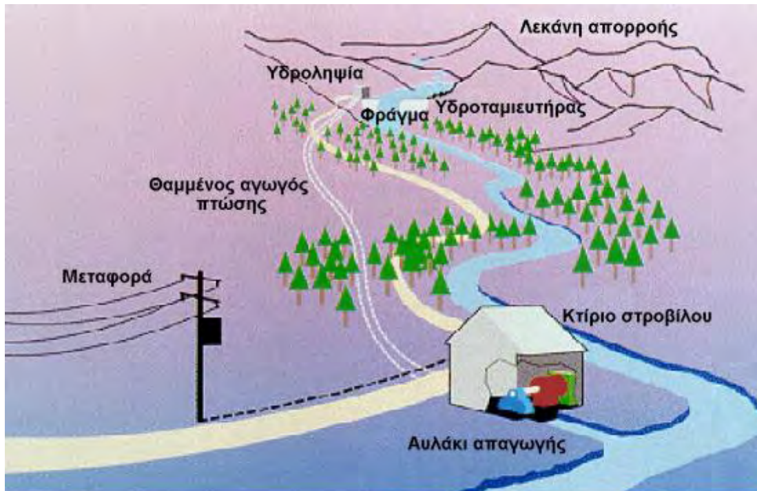
Σχήμα 2.1: Τα κύρια μέρη ενός Υ/Η σταθμού[5]
