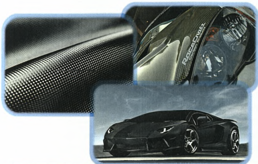
Εικόνες 20-21: Επένδυση με ανθρακονήματα στο εσωτερικό και εξωτερικό μέρος αυτοκινήτων
