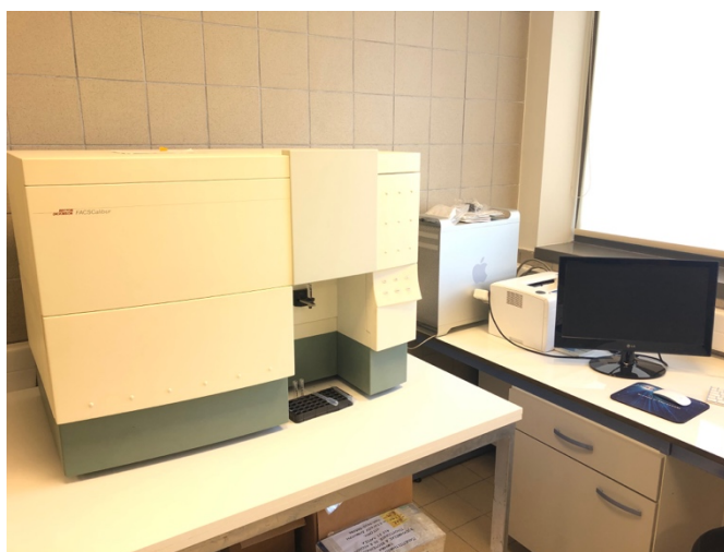
Εικόνα 34: : Το κυτταρόμετρο ροής FACScalibur του εργαστηρίου φυσιολογίας ζωικών οργανισμών όπου έγιναν οι μετρήσεις καθώς και ο υπολογιστής με το λογισμικό BD Cell Quest.
