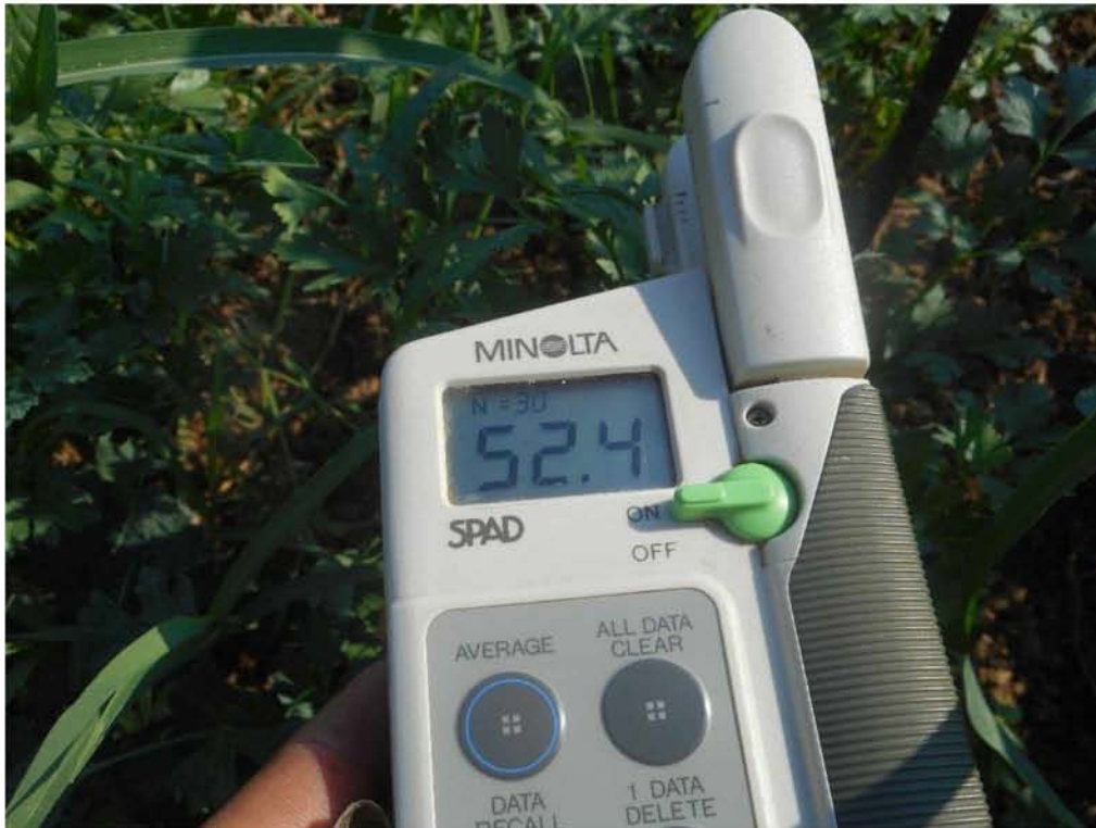
Εικόνα 8. Όργανο μέτρησης της σχετικής συγκέντρωσης της χλωροφύλλης (SPAD-502 chlorophyll meter, Konica Minolta Optics Inc.)
