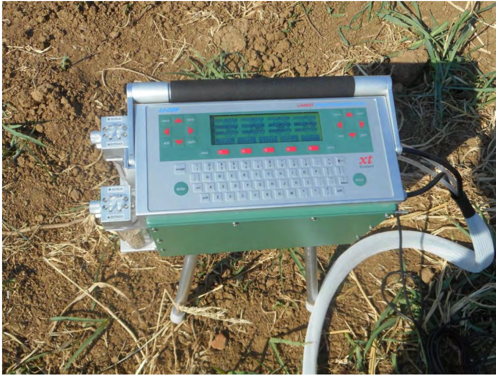
Εικόνα 9. Φορητό όργανο LI-6400 XT για υπολογισμό φωτοσυνθετικής ικανότητας και της στοματικής αγωγιμότητας των φύλλων.
