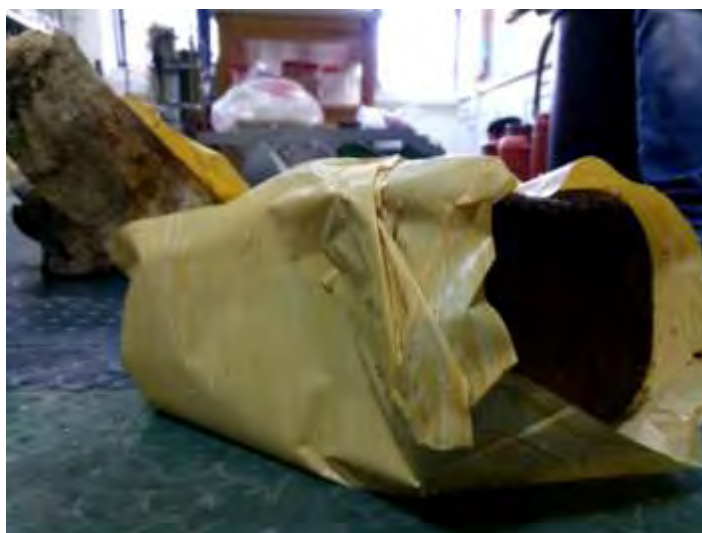
Εικόνα 16. Καθαρισμός με τη χρήση χαρτοπολτού υγροποιημένου με μίγμα ακετόνης, αιθανόλης και ύδατος
