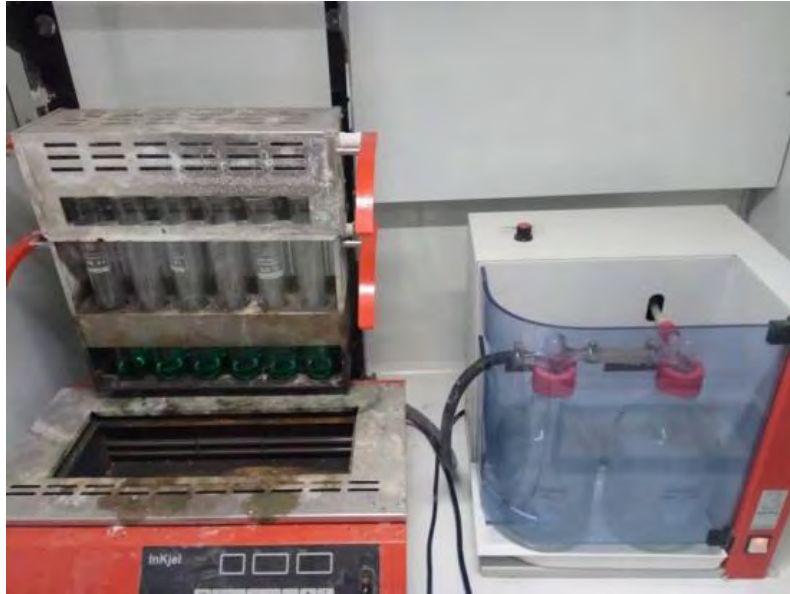
Εικόνα 11: Διαδικασία της πέψης στη συσκευή Kjeltec
