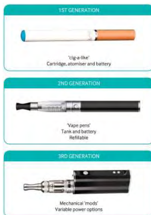
Εικόνα 10: Διαφορετικοί τύποι συσκευών ηλεκτρονικού τσιγάρου.
