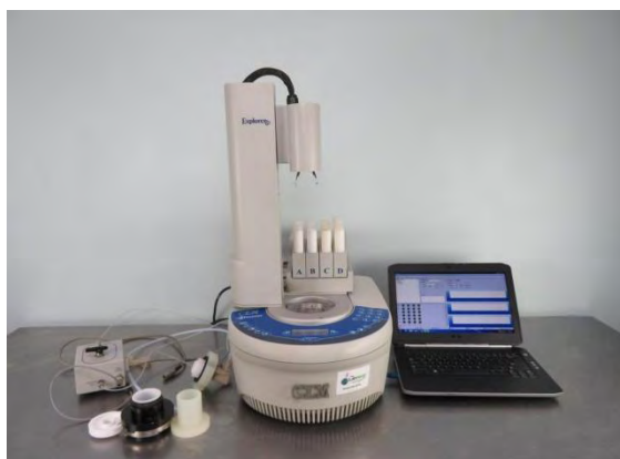
Εικόνα 8 : CEM Microwave, Αντιδραστήρας με αυτόματο συλλέκτη δειγμάτων
