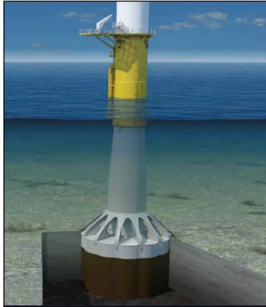
Σχήμα 3.6: Θεμελίωση με τη μέθοδο της αναρρόφησης ( https://www.vanoord.com ).
