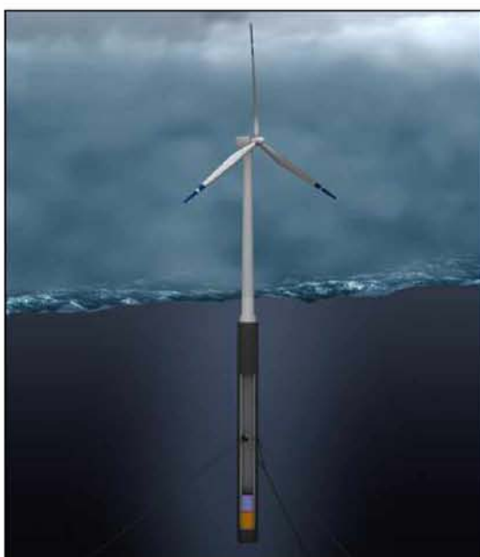
Σχήμα 3.7: Θεμελίωση με Spar-buoy ( https://www.materialstoday.com ).
