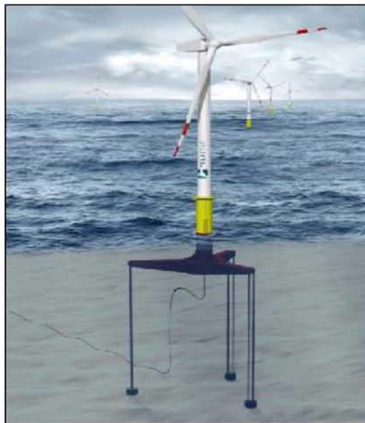
Σχήμα 3.9: Θεμελίωση με TLP ( https://en.paperblog.com ).
