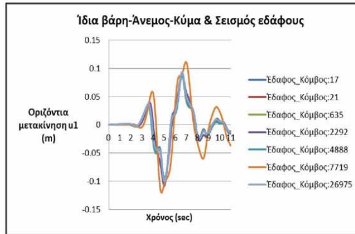
Σχήμα 8.107: Οριζόντιες μετακινήσεις των κόμβων του εδάφους συναρτήσει του χρόνου, για την άργιλο 2.
