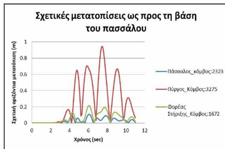
Σχήμα 8.106: Σχετικές μετακινήσεις των 3 σημείων των μεταλλικών μελών ως προς τη βάση του πασσάλου σε συνάρτηση με το χρόνο.
