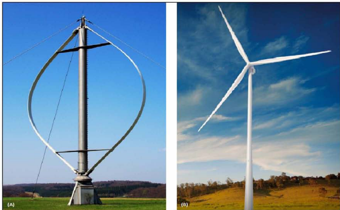
Σχήμα 2.3: (A) Ανεμογεννήτρια κατακόρυφου άξονα Darrieus (μεγάλου μεγέθους) και (B) ανεμογεννήτρια οριζόντιου άξονα ( http://www.zeroenergybuildings.org και https://www.ge.com ).
