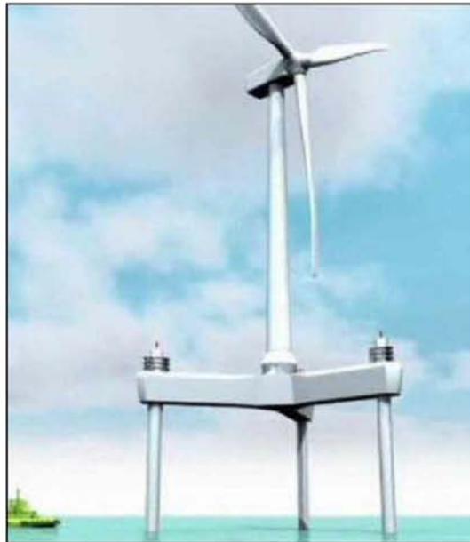
Σχήμα 3.3: Θεμελίωση τριπλού πύλωνα (Μακρή, 2013).
