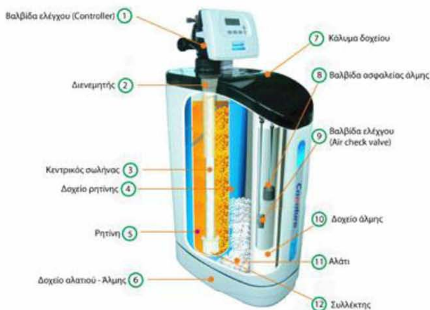
Σχήμα 1.16: ΣΧΗΜΑΤΙΚΗ ΑΠΕΙΚΟΝΙΣΗ ΑΦΑΛΑΤΩΣΗΣ ΜΕ ΙΟΝΤΟΑΝΤΑΛΛΑΓΗ
