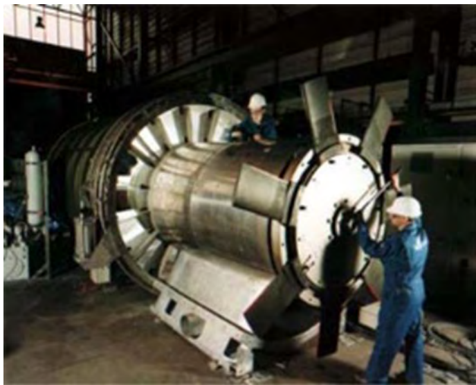
Εικόνα 3-6: Τουρμπίνη Wells που χρησιμοποιήθηκε στην εγκατάσταση LIMPET Πηγή: Ocean Wave Energy, Cruz(2008)
