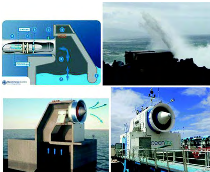
Εικόνα 3-4: Pico OWC, σχήμα (πάνω αριστερά) και σε λειτουργία (πάνω δεξιά), OceanLynx, σχήμα (κάτω αριστερά), πραγματική φωτογραφία συσκευής (κάτω δεξιά) ( Πηγή: Handbook of Ocean Wave Energy, Jens Peter Kofoed(2017) )
