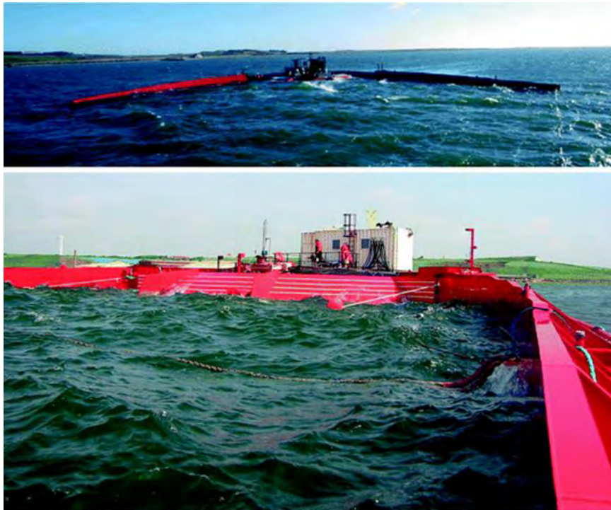
Εικόνα 3-32: Wave Dragon πρωτότυπο κλίμακας 1:4.5 συνδεδεμένο με το δίκτυο, δοκιμή στο Nissum Bredning, Denmark
