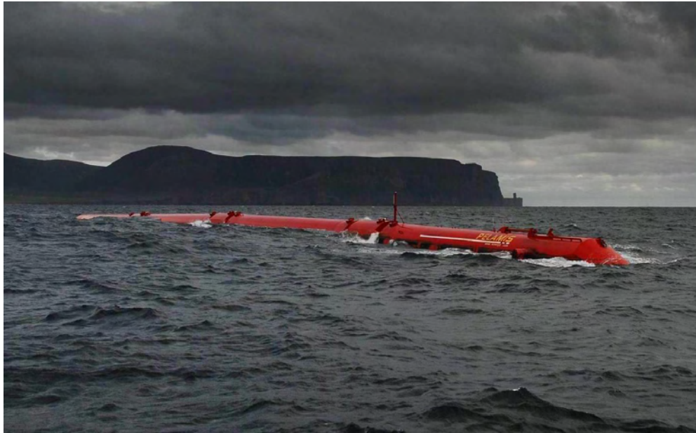
Εικόνα 1-5: The Pelamis Prototype machine at EMEC, Orkney, Scotland, 2007, 750(kW)
