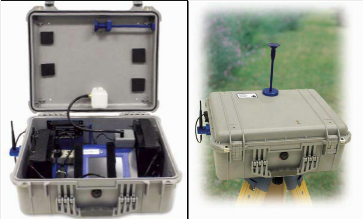
Εικόνα 7: χρήση του Dust Trak II με εξωτερικούς χώρους με αυτόματη λειτουργία
