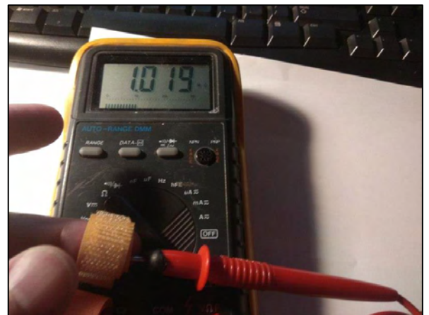
Εικόνα 33 Ωμομέτρηση με εφίδρωση
