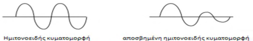
Εικόνα 6: Ημιτονοειδής κυματομορφή – Αποσβημένη ημιτονοειδής κυματομορφή
