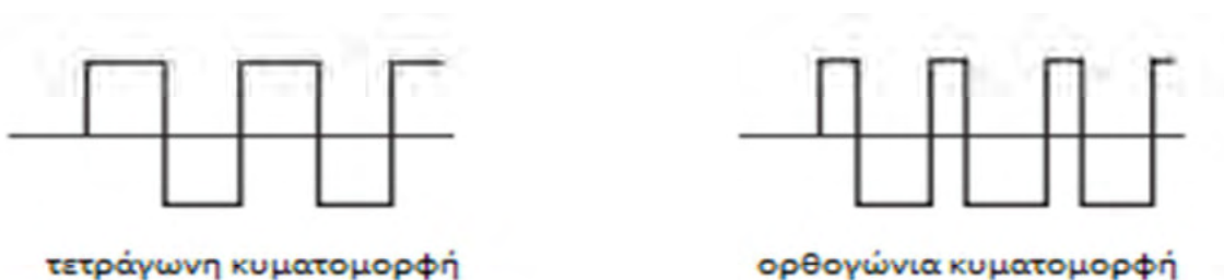
Εικόνα 7: Τετράγωνη κυματομορφή – Ορθογώνια κυματομορφή
