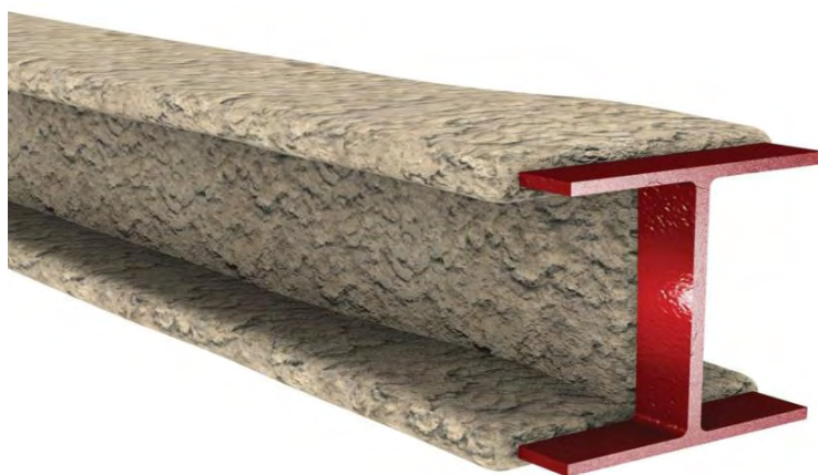
Εικόνα 16: Βερμικουλίτης γύρω από μεταλλική δοκό (πηγή: https://www.progressivematerials.com.au/product/vermiculite-spray/ )
