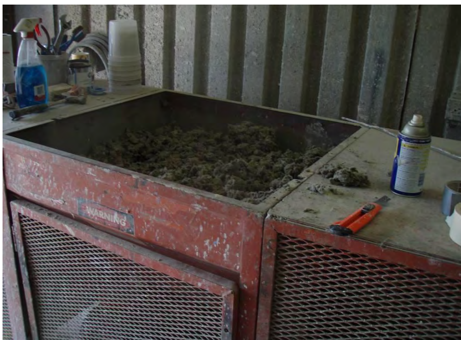
Εικόνα 18: Υγρό μείγμα εκτοξευόμενου πυράντοχου υλικού (πριν την εφαρμογή του στο μεταλλικό δομικό μέλος) ( https://cdn.ymaws.com/www.sfpe.org )
