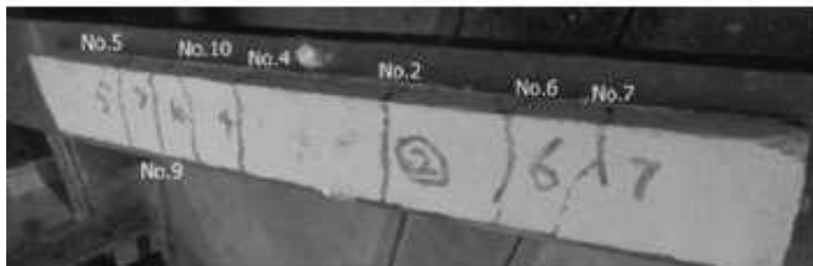
Εικόνα 26: Αστοχία του SFRM στην εφελκυστική πλευρά (πηγή: http://eeme.ntua.gr/proceedings/9th/Papers/089_PAP_Zografopoulou.pdf )
